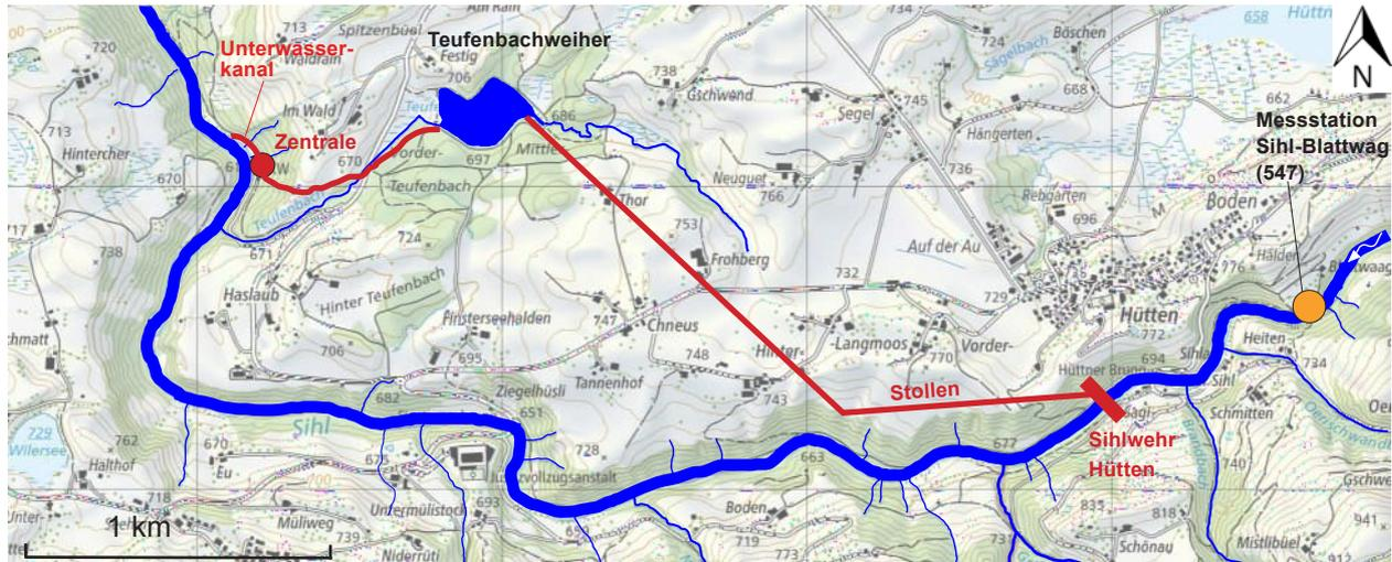
**Abbildung 1** Schematische Darstellung des Perimeters des Kraftwerks Waldhalde.
