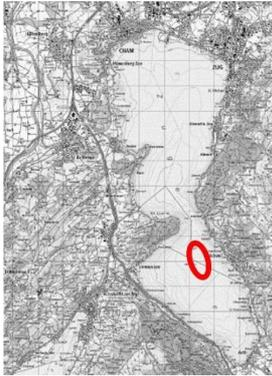
Das Tiefenwasser des Sees wird künstlich während des ganzen Jahres mit Sauerstoff angereichert. Im Bereich der tiefsten Stelle wird über zahlreiche Fein-Düsen Sauerstoff eingeblasen (z. B. sternförmige Diffusoren). Über auf dem Seegrund verlegte Leitungen wird Sauerstoff mittels Kompressoren an den vorgesehenen Eintragsstellen am Seegrund eingetragen. Die Eintragsstellen/Diffusoren werden mit Bojen markiert. Ein Betriebsgebäude mit den benötigten Anlagen liegt z. B. in Walchwil im Uferbereich.
