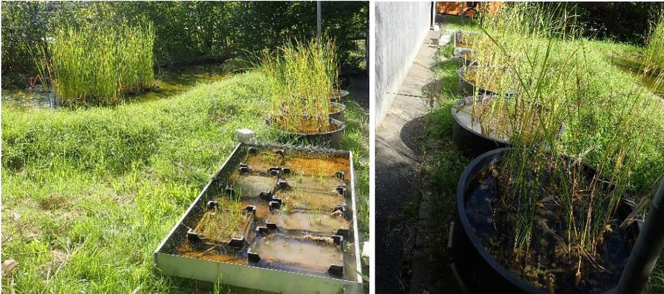
Foto 12 und 13: Testgelände an Land mit flacher Wanne, Rundbecken sowie Folienteich.
