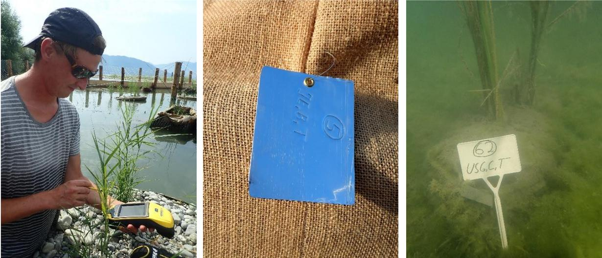
Foto 43-45: Vermessung mittels GPS und Doppelmeter. Alu- und Plastiketiketten.
