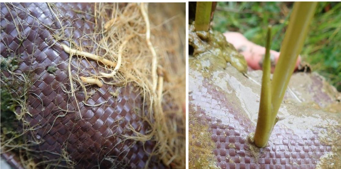
Foto 79, 80: Detailansicht der Durchwurzlung (links) sowie Triebdurchbruch (rechts) durch den Bioplastiksack.
