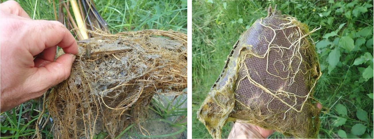
Foto 77, 78: Foto links: komplett durchwurzelter Jutesack nach rund 9 Monaten (seitliche Sicht). Foto rechts: Bioplastiksack weist nur schwache Durchwurzlung nach 9 Monaten auf (Sicht auf die Unterseite).
