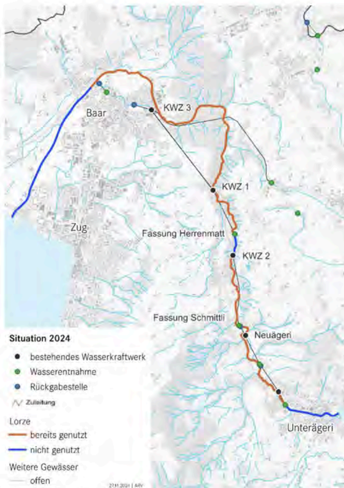
Abbildung 6: Die Kraftwerke inklusive Wasserentnahme und -rückgabestellen entlang der oberen Lorze
