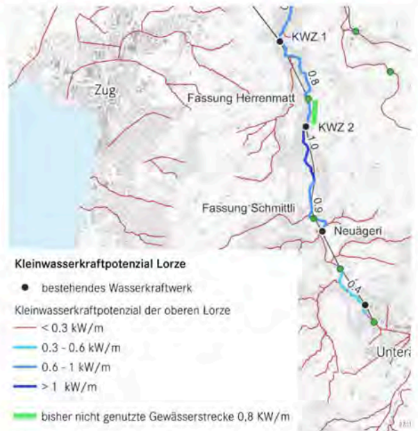
Abbildung 11: Kleinwasserkraftpotenzial der Lorze sowie Darstellung der bisher nicht genutzten Gewässerstrecke (map.admin.ch, BFE)
