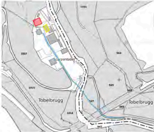
Abbildung 7: Standort der neuen Zentrale im Gebiet Lorzentobel: rot = neue Zentrale, gelb = Abbruch Lagergebäude, blaue Linie = geplante Baustellenzufahrt mit temporärer Hilfsbrücke (Grundbuchplan; 3D Ansicht ZugMap; Lage des neuen Gebäudes schematisch)
