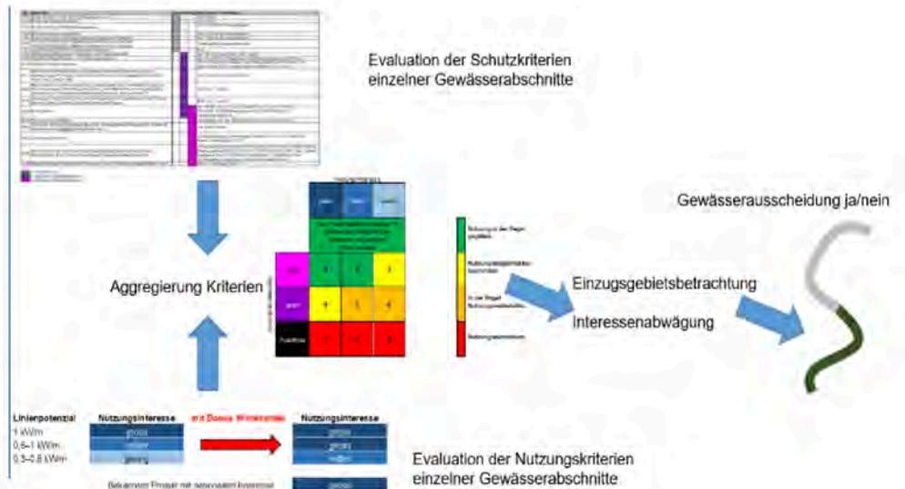
Abbildung 12: Arbeitsschritte zur Bestimmung der geeigneten Gewässerstrecken mittels 3x3 Matrix zur Einstufung der Eignung (Vollzugshilfe, BFE)
