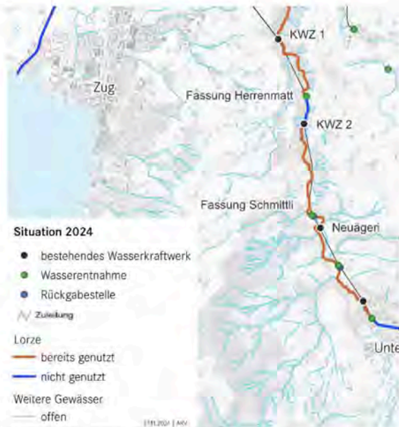
Abbildung 10: Die Kraftwerke inklusive Wasserentnahme und -rückgabestellen entlang der Lorze; bereits genutzte und ungenutzte Gewässerstrecken
