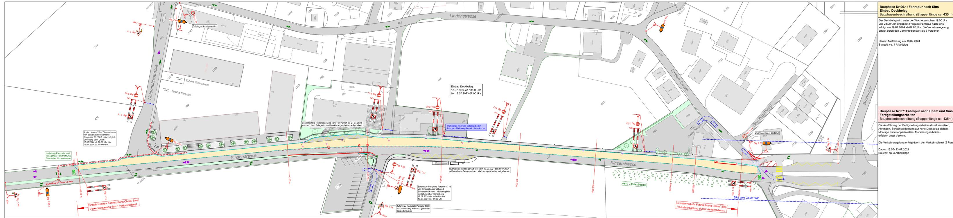
**Bauphase Nr 06.1: Fahrspur nach Sins Einbau Deckbelag**
