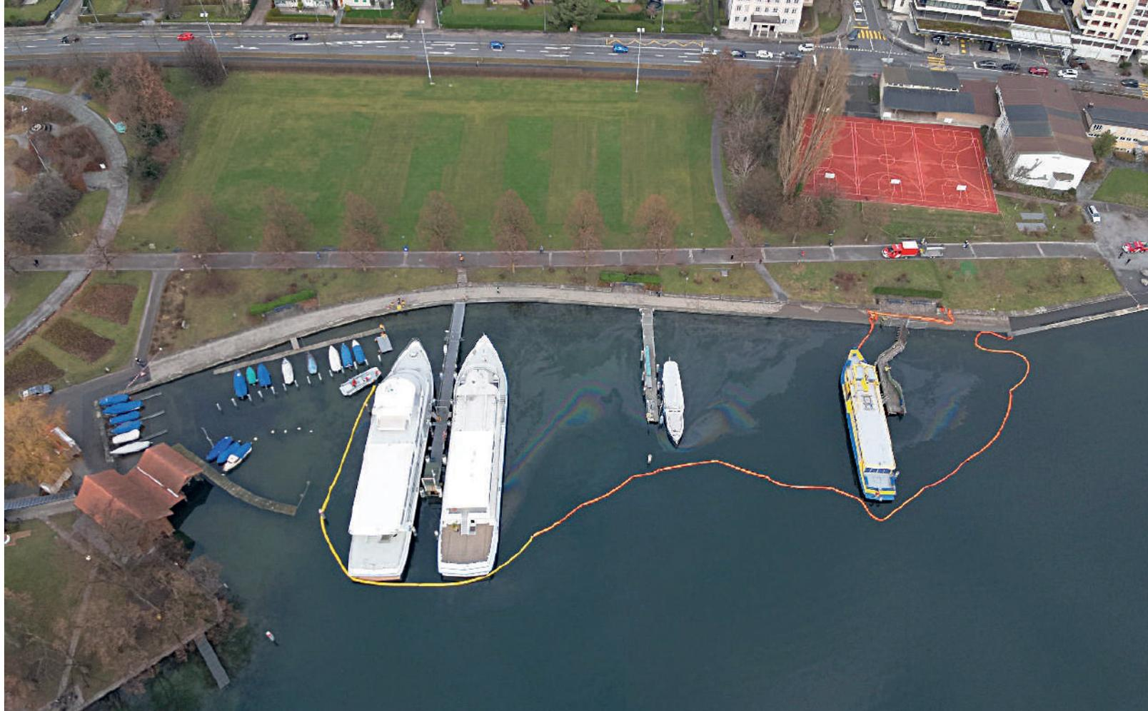
Abbildung 1: Rund um den schillernden Ölfilm zwischen den vier Schiffen ist die von der FFZ erstellte gelb-orange Ölsperre erkennbar; das zweite Schiff von rechts ist die «MS Schwan».
