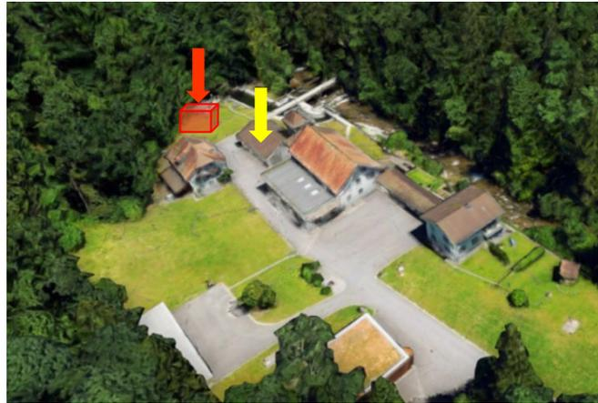
Abbildung 7: Standort der neuen Zentrale im Gebiet Lorzentobel: rot = neue Zentrale, gelb = Abbruch Lagergebäude, blaue Linie = geplante Baustellenzufahrt mit temporärer Hilfsbrücke (Grundbuchplan; 3D Ansicht ZugMap; Lage des neuen Gebäudes schematisch)
